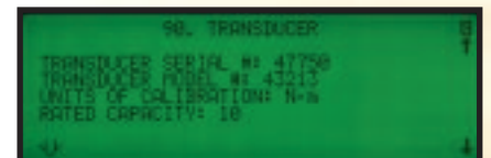
Details zum angeschlossenen Messwertgeber werden nach Drücken der Taste # angezeigt.
